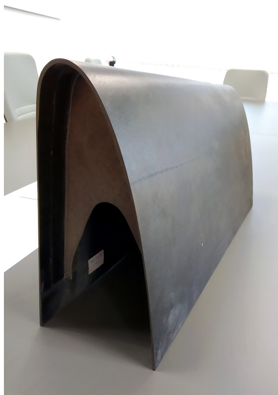
La pièce composite finale d'une aile d'avion courbe, produite avec la technologie FDM.
