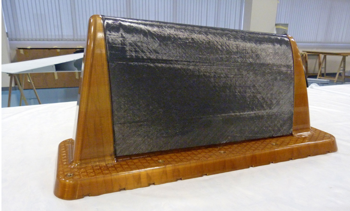
L'outil de préforme offrait des propriétés mécaniques idéales résistant aux températures élevées, ce qui a permis à l'équipe de réduire l'étape de chauffage de la fibre de carbone d'une heure à dix minutes.
